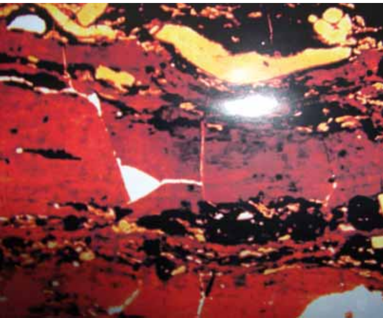
1 Уголь под микроскопом. Шлиф (тонкая пластинка), проходящий свет, 200-кратное увеличение. Серое (красное) — гелифицированный компонент угля — основной носитель германия. Белые пятна — участки разрушенного угольного шлифа
